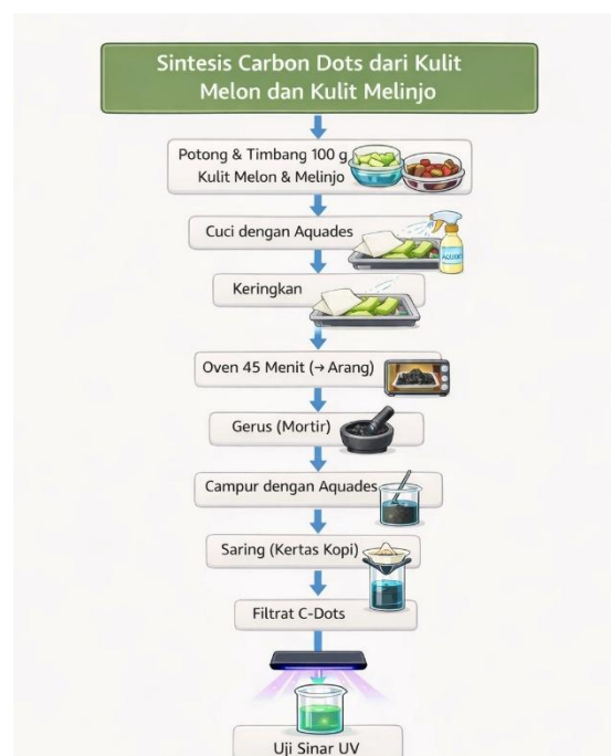
Gambar 1. Diagram alur sintesis Carbon Dots dari kulit melon dan melinjo
